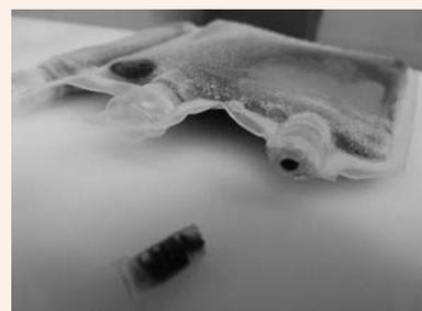
③物理的要因やピンホールから流入した液体窒素による破損（故意に破損させたもので実際とは異なります）
